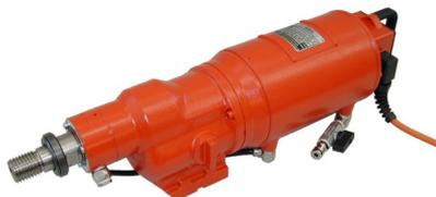
Leistungsstarke Profi-Kernbohrmaschine zum Nassbohren mit robustem Vollmetallgehäuse, patentierter Wasserkühlung und AF-Leichtlöse-Element für Bohrkronen. Die WEKA DK 42 E ist ein sehr robuster, geschlossener und wartungsarmer Motor. Da er keine rotierenden Wicklungen enthält, ist er sehr langlebig.
