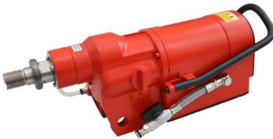
Leistungsstarke Profi-Kernbohrmaschine zum Nassbohren mit robustem Vollmetallgehäuse, patentierter Wasserkühlung und AF-Leichtlöse-Element für Bohrkronen. Die WEKA SR 38 ist ein sehr robuster, geschlossener und wartungsarmer Motor. Da er keine rotierenden Wicklungen enthält, ist er sehr langlebig.
